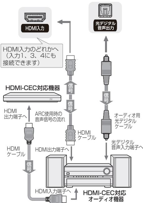
※eARC/ARC 対応のオーディオ機器を、eARC/ARC 対応の HDMI ケーブルで HDMI 入力 2 (eARC/ARC) 端子に接続する場合は、光デジタルケーブルの接続は不要です。
