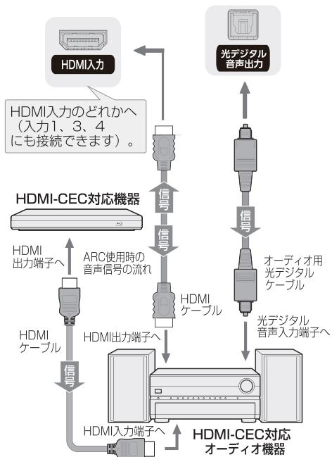
※eARC/ARC 対応のオーディオ機器を、eARC/ARC 対応の HDMI ケーブルで HDMI 入力2(eARC/ARC) 端子に接続する場合は、光デジタルケーブルの接続は不要です。
