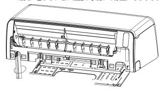
**④下部カバーを元の位置に確実に取り付け、ネジで止める**
