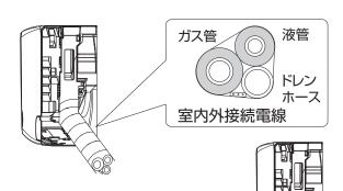
◆室内ユニット配管取り出し方向 配管は、後、左、右、下、左後、 左下から取り出せます。
