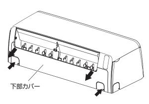
b. 下部カバーの下部を矢印の方向に押しながら、上部 を手前に引き、取りはずす
